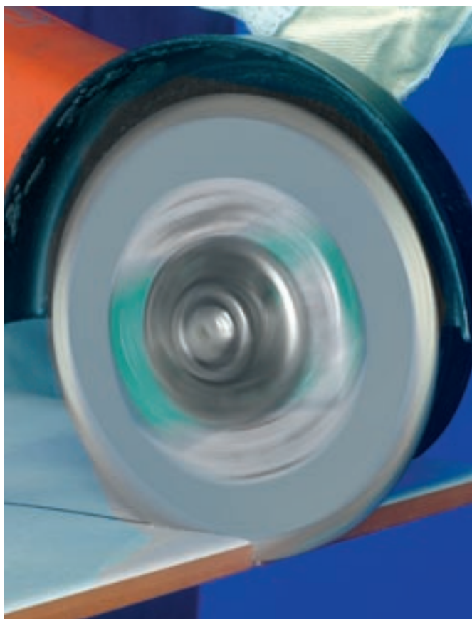
Keraminės plytelės pjovimas.
