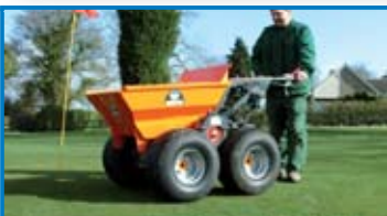
Flotacinės padangos, pritaikytos minkštam pagrindu
