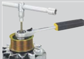
Alternatoriaus skriemulys paprastai būna priveržtas 24 mm veržle.
