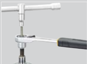
Amortizatorių montavimui paprastai reikalingos 22 mm galvutės.
